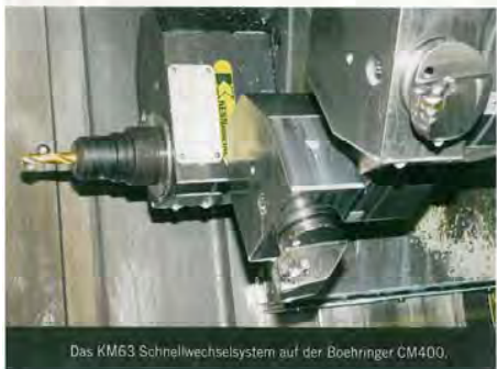
Das KM63 Schnellwechselsystem auf der Boehring CM400.
